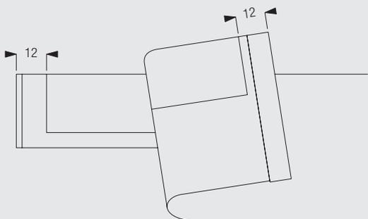
La distance entre la bande magnétique 10398 et l'extrémité du profil est de 12mm.
